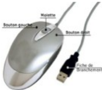
Illustration 4: Une souris à molette et sa fiche de branchement
