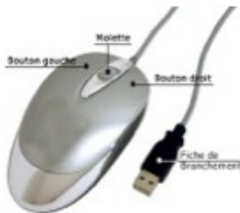
Illustration 4: Une souris à molette et sa fiche de branchement
