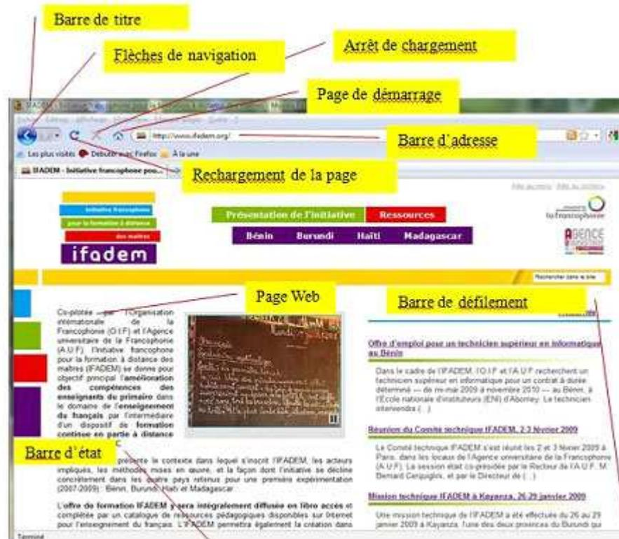
Figure 1 : Interface d'un navigateur Web
